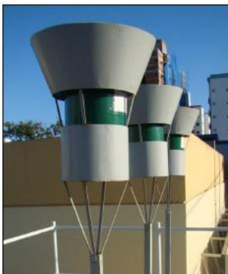
Figura 06: Aparato para coleta de poeira sedimentável.
