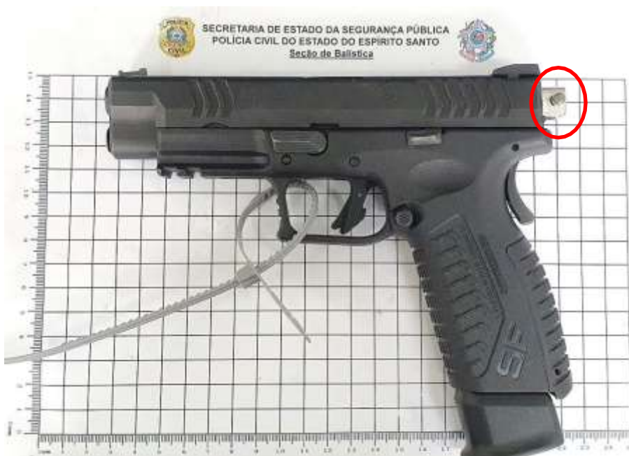
Imagens: Evidenciam dispositivo seletor conversor de funcionamento.
