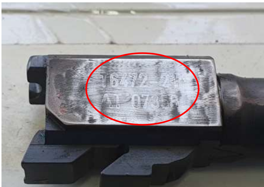
Imagem: Evidencia número de série revelado no cano de pistola durante exame metalográfico.
