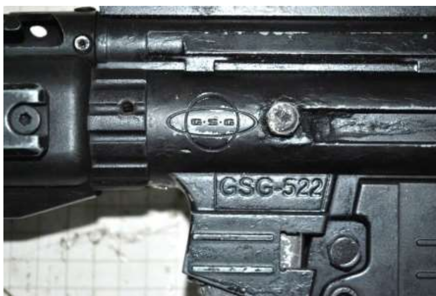
Imagem: Mostra rifle de airsoft elétrico, originalmente de calibre 6 milímetros, transformado em arma de fogo.
